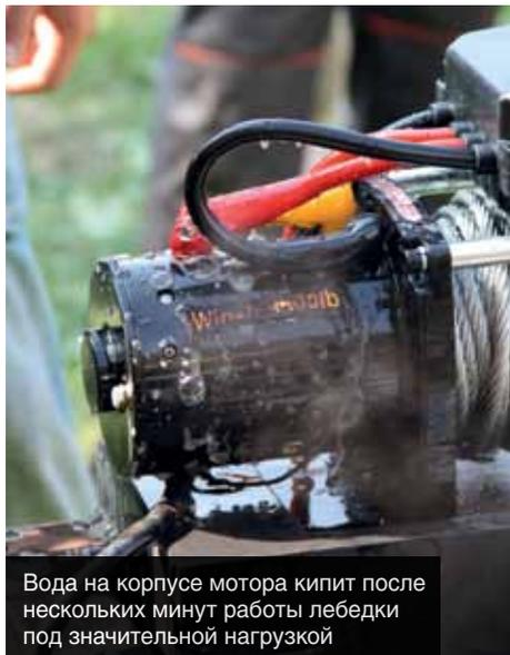
Вода на корпусе мотора кипит после нескольких минут работы лебедки под значительной нагрузкой
