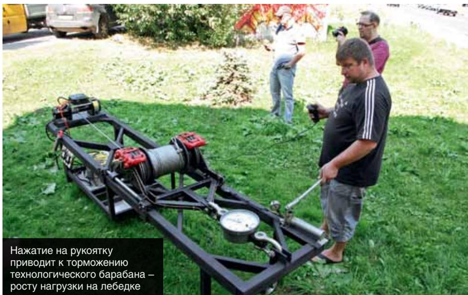
Нажатие на рукоятку приводит к торможению технологического барабана – росту нагрузки на лебедке
