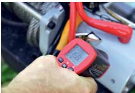
Замер температуры электронным дистанционным термометром
