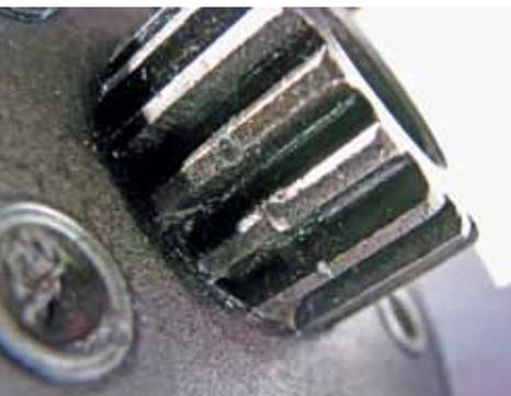
Это и последующие фото наглядно демонстрируют качество металла шестерен и уровень его термообработки
